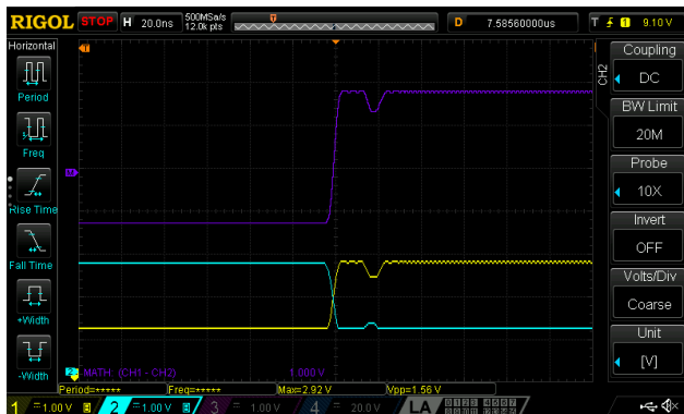
0 m, ohne Abschluss: Unterschwinger ca. 20 ns (20 ns/div)
