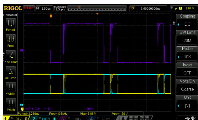
6 m, ohne Abschluss (Übersicht 2 \mu s/div)
