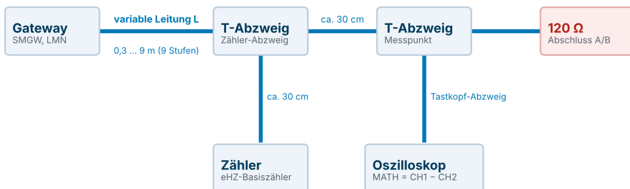
Bild 2: Messaufbau Gruppe B, variable Leitung L zwischen Gateway und Zähler.
