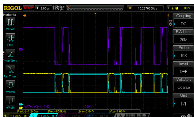
9 m, ohne Abschluss (Übersicht 2 \mu s/div)
